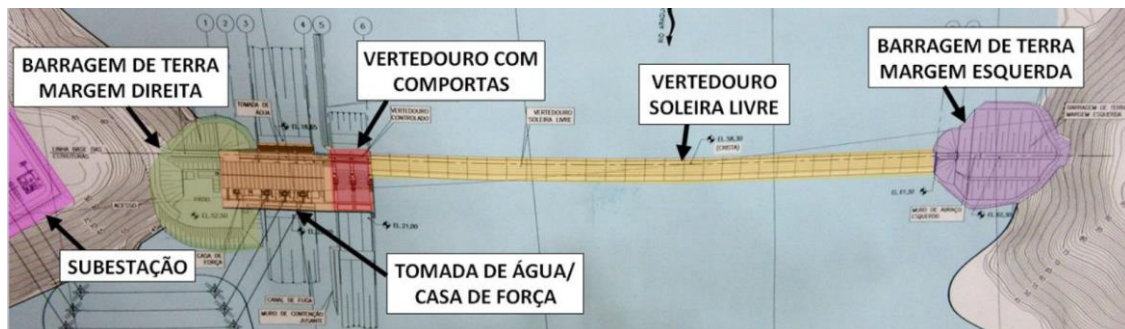
Figura 7. Conformação do barramento da UHE Cachoeira Caldeirão. Fonte: Empresa de Energia Cachoeira Caldeirão S.A.
